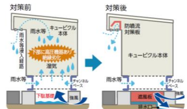
キュービクルの雨水等浸入対策
