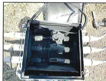
〔落雷による焼損〕 上：外観 下：内部
