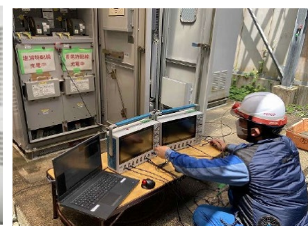
画像や測定器による機器劣化診断
