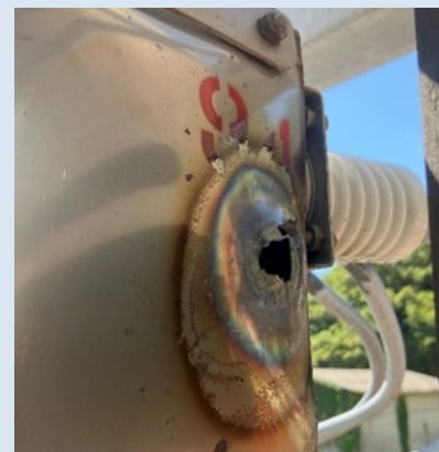
錆による区分開閉器破損(施設後約30年)
