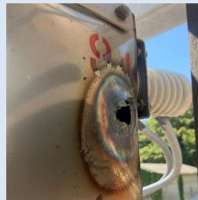
錆による区分開閉器破損(施設後約30年)
