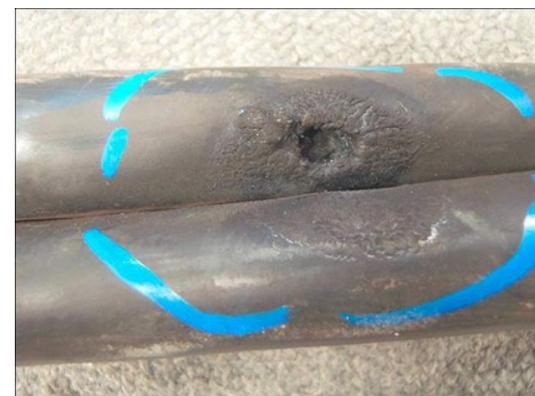
水トリ-による絶縁破壊事例
