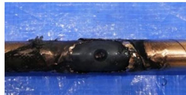
絶縁破壊したケーブルの
