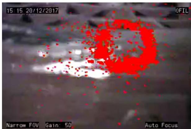
故障モールド変圧器の部分放電
